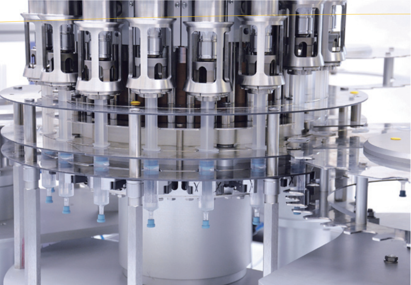
Bedrukkings- en assemblagemachine van Grauel, actief voor de medisch-farmaceutische industrie. Grauel is verantwoordelijk voor een kwart van de omzet van AAE.
